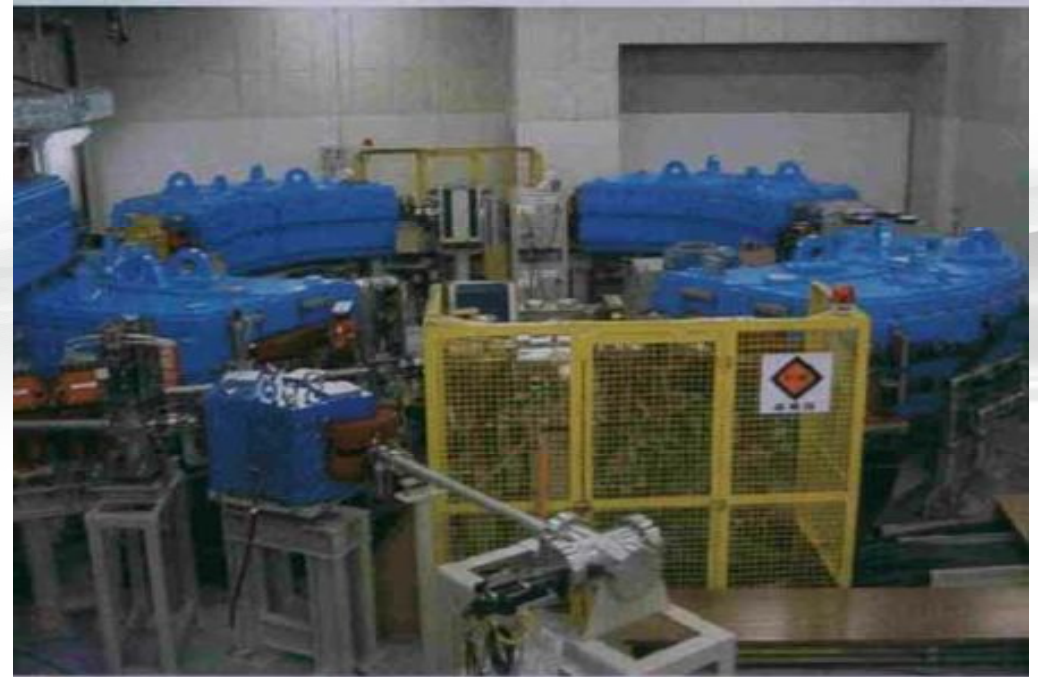
Le synchrotron à protons de Suizuoka (Japon). Diamètre : 8 mètres
